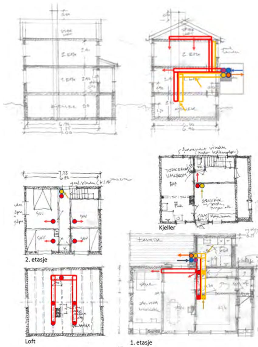
Forslag til montering av balansert ventilasjonsanlegg.
