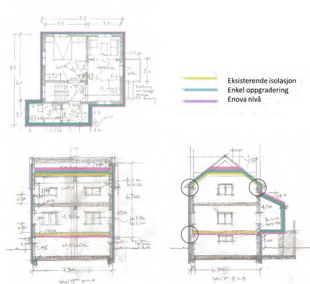
Plan- og snittegninger av huset i Børselev med markering av tilleggisolering som enkel oppgradering og oppgradering til Enova-nivå. Sirklene viser overganger mellom tak og vegg og vegg og kjeller som må planlegges spesielt.
