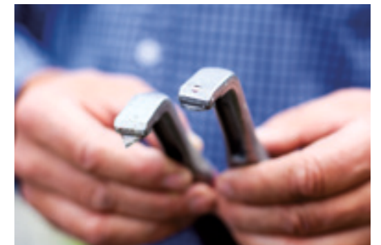
Profilskraper: Til treverk med mange profiler og detaljer, er det bra med skraper med buet eller spiss form.
