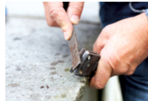
Sette opp: Å sette opp en skraper er ikke vanskelig. Bruk en metallfil, og slip eggen med noen jevne tak.
